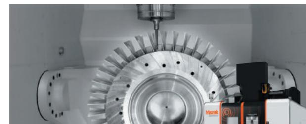
Eixo-árvore cônico rígido nº 50 e capacidade de torneamento completam a usinagem de peças complexas com uma única máquina
