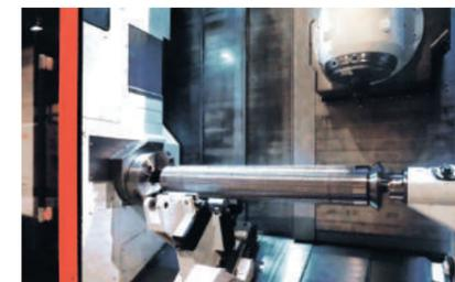
A INTEGREX e-500H II usina rolos em uma única configuração de máquina
