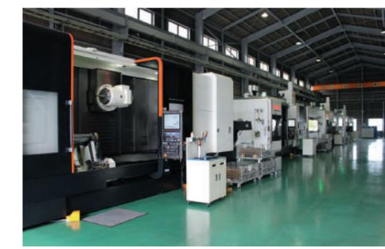
Área de usinagem composta da série INTEGREX para processar os componentes principais do GUZZILLA
